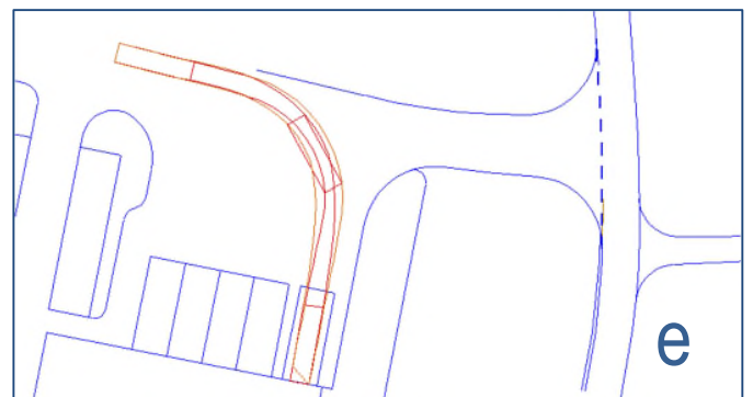
Abbildungen 6: Fahrkurven eines 3-achsigen Müllfahrzeug ohne Nachläufer mit einer Länge von 10,00 m
