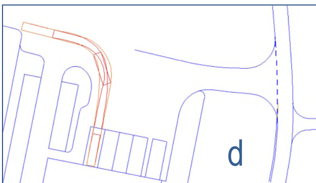
Abbildungen 6: Fahrkurven eines 3-achsigen Müllfahrzeug ohne Nachläufer mit einer Länge von 10,00 m
